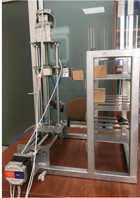
Şekil 5.13. Görüntü işleme ile tespit edilen ürünün ilgili istasyona götürülmesi
