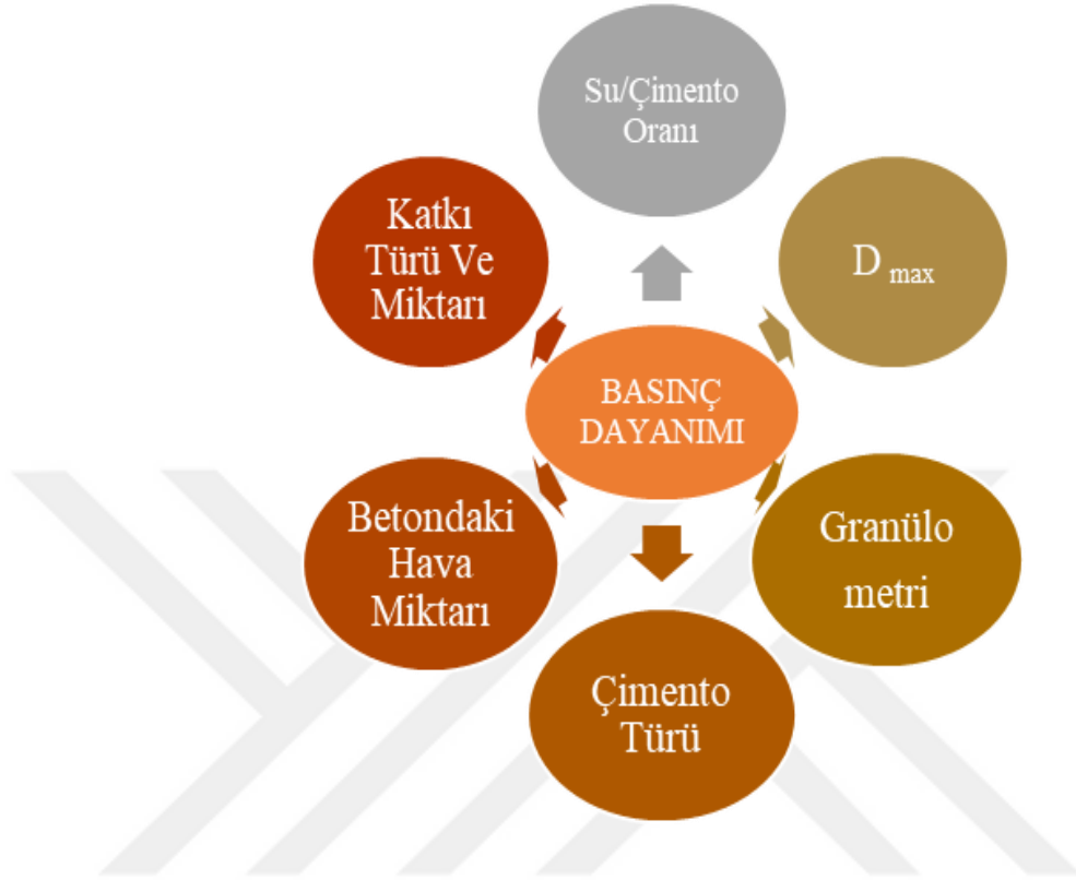
Şekil 3.1. Betonun basınç dayanımını etkileyen parametreler
