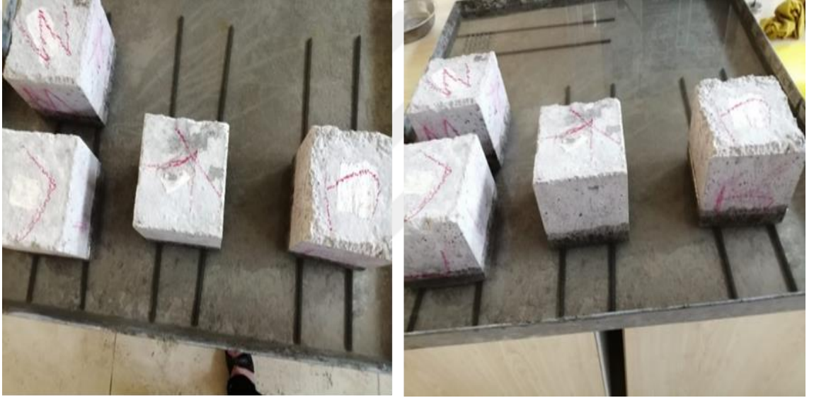
Şekil 4.8. Kılcal su emme deneyinden alınan bir görüntü
