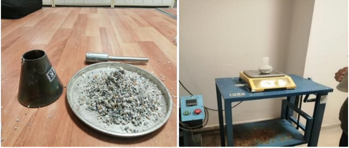
Şekil 4. 5. İnce agrega özgül ağırlık deneyi
