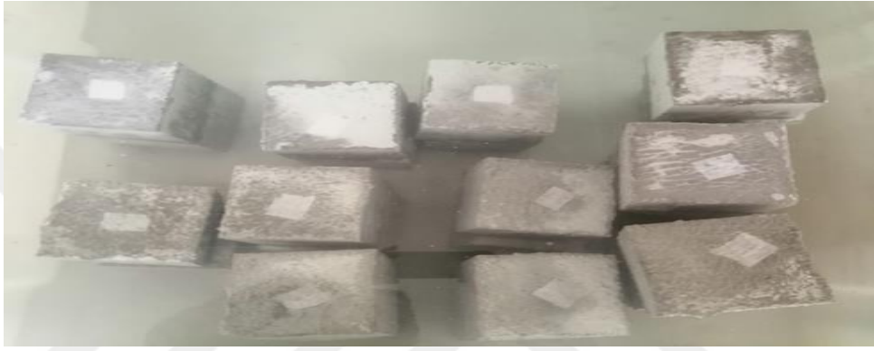
Şekil. 4.6. Yüksek dayanım beton bakımı
