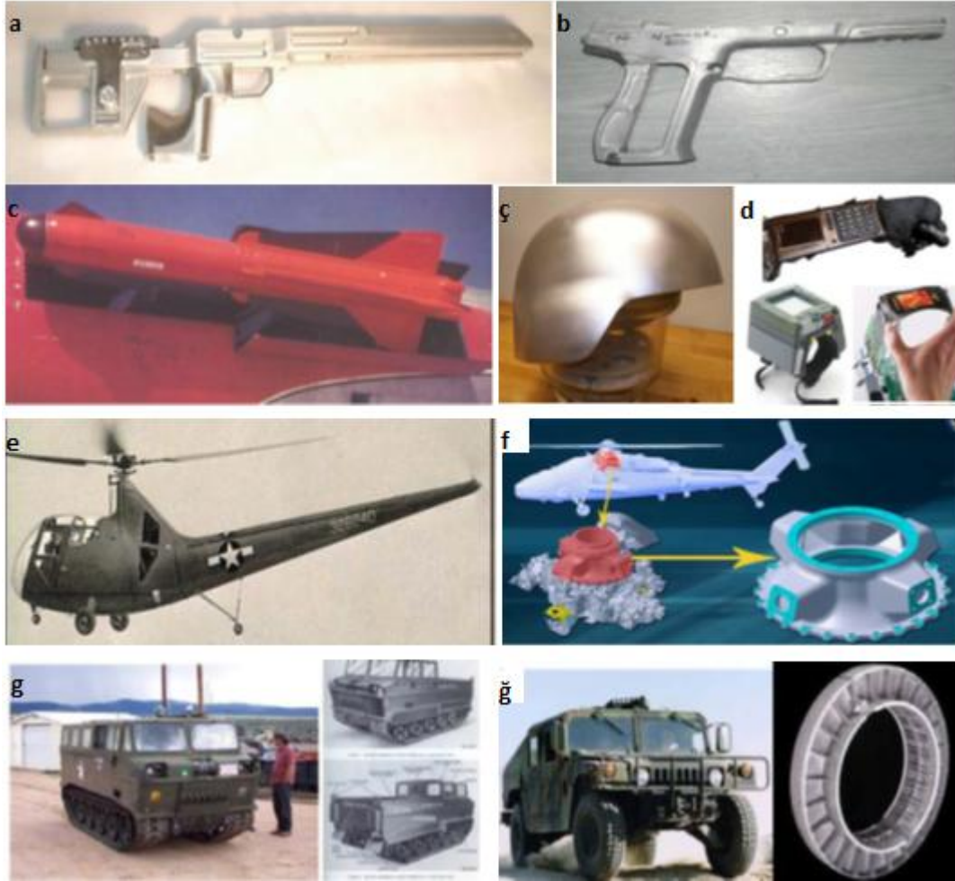
Şekil 2.16. a) Magnezyum alaşımlı tüfek gövdesi, b) Magnezyum alaşımlı tabanca gövdesi, c) Magnezyumdan imal edilen Falcon GAR-1 füzesi, ç) Magnezyum alaşımlı kask prototipi, d) Magnezyum alaşımlı kola giyilebilen led ekranlar, e) Magnezyum alaşımlı R-6 helikopteri, f) Atak Helikopteri'nin magnezyum alaşımlı dişli kutusu üst gövdesi, g) Magnezyum alaşımlı Husky M-116 taşıyıcı, kargo, çıkarma aracı, ğ) HMMWV askeri araçlarındaki magnezyum alaşımlı "run flat" tekerlekler [48].
