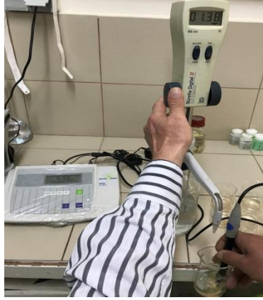
Şekil 3.9. Titre edilebilir asitlik ölçümü.
