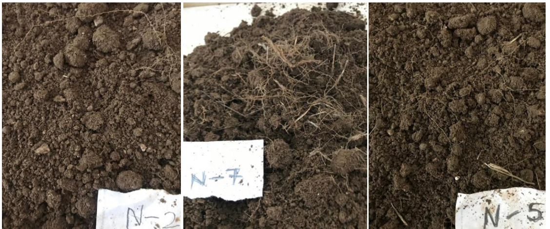
Şekil 3.9 Nadas alanından alınan bozulmuş toprak örnekleri
