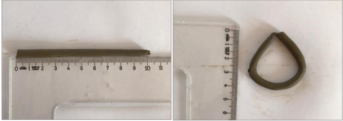
Şekil 3.25 Toprak örneklerinde plastiklik ölçümü
