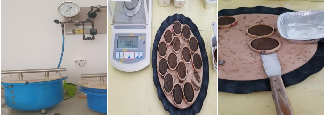
Şekil 3.15 Tarla kapasitesi ve solma noktası analizleri
