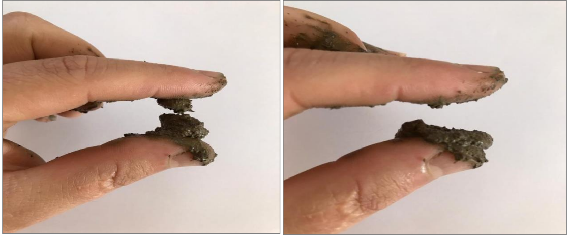
Şekil 3.24 Toprak örneklerinin yapışkanlığının belirlenmesi
