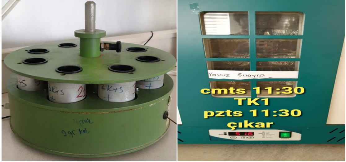
Şekil 3.16 Agregat stabilitesi analizi
