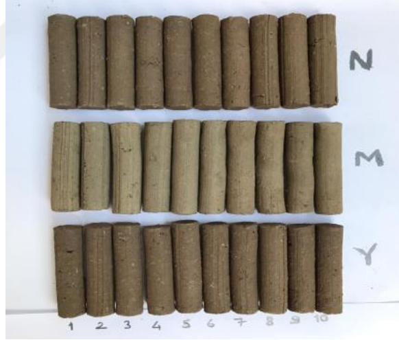
Şekil 3.17 Toprak örneklerinde uzama katsayısının belirlenmesi
