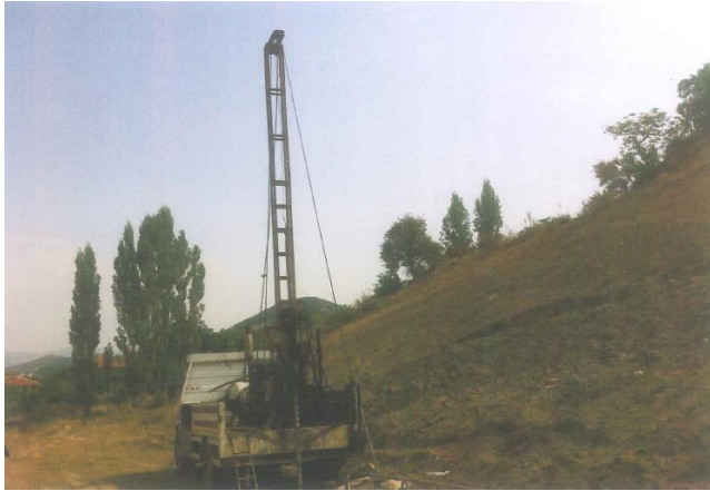
Şekil 3. 23 Şevin Topuk Bölgesinde Yapılan SPT Deneyleri (Gürdal, 2017)
