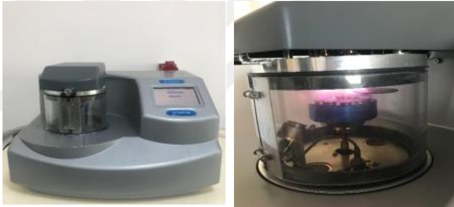
Şekil 3. 10. Altın kaplama cihazı ve örneklerin SEM’de altın kaplanması
