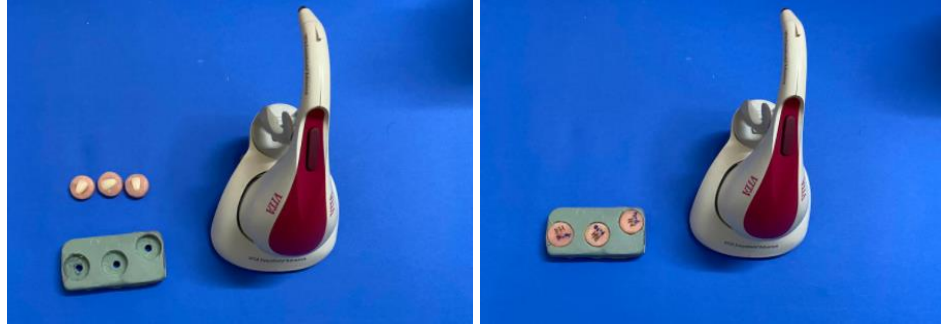
Şekil 3 6. Renk ölçüm cihazı, örnekler, renk ölçümü için hazırlanmış silikon indeks ve örneklerin silikon indekse yerleştirilmesi
