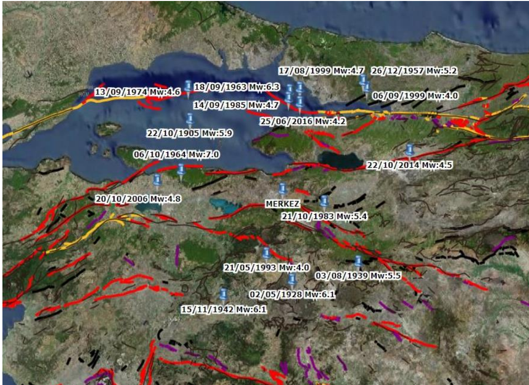
Şekil 4.11 : Bursa inceleme alanı merkezi etrafındaki diri faylar ve gerçekleşen bazı depremler, http://yerbilimleri.mta.gov.tr 'den uyarlanmıştır.
