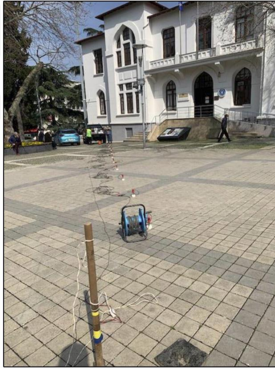
Foto B.5 : MASW deneyinin düzenlendiği Hacılar Cami ile Atatürk Anıtı arasındaki kısım ve MASW deneyinde uygulanmış sismik serim.
