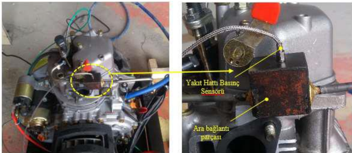
Şekil 3.2. Yakıt hattı basınç sensörü ara bağlantı parçasının yakıt hattı borusuna montajı
