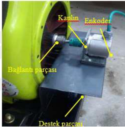
Şekil 3.4. Encoderin motor üzerine montajı
