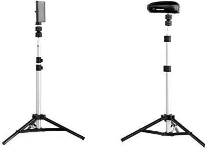
Şekil 3.3: Smart speed fotosel cihazı.
