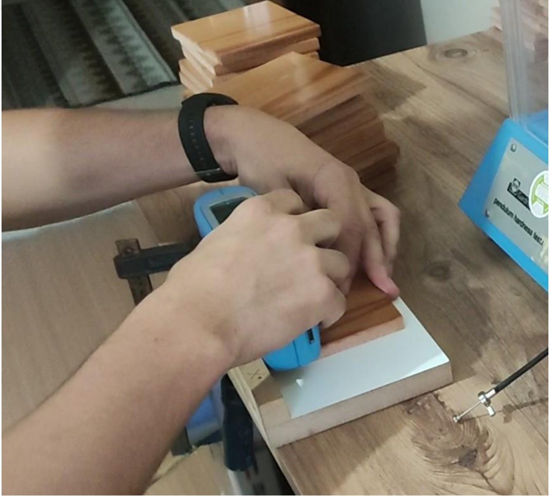
Şekil 15. Vernik sistemlerinin yüzey parlaklığının ölçülmesi
