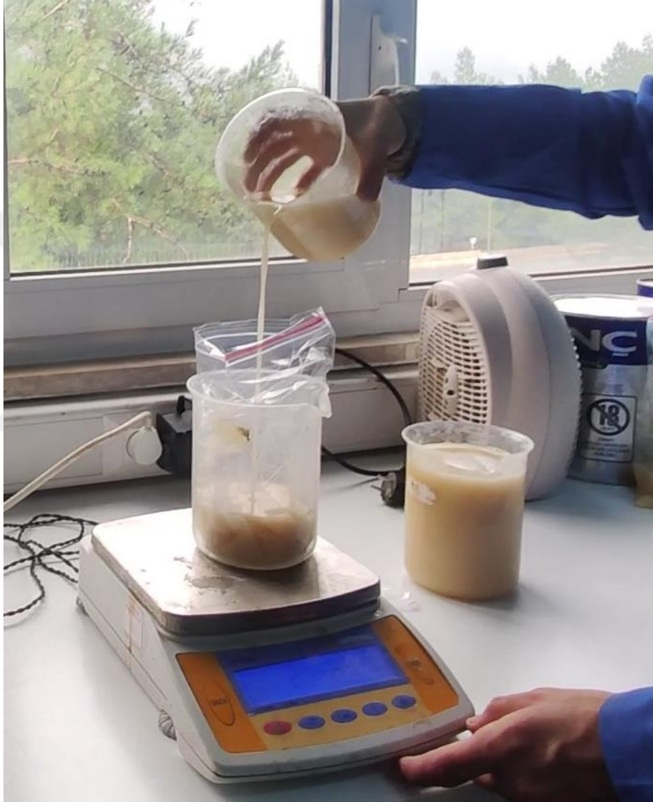
Şekil 6. Vernik bileşenlerinin ağırlıkla ayarlanması
