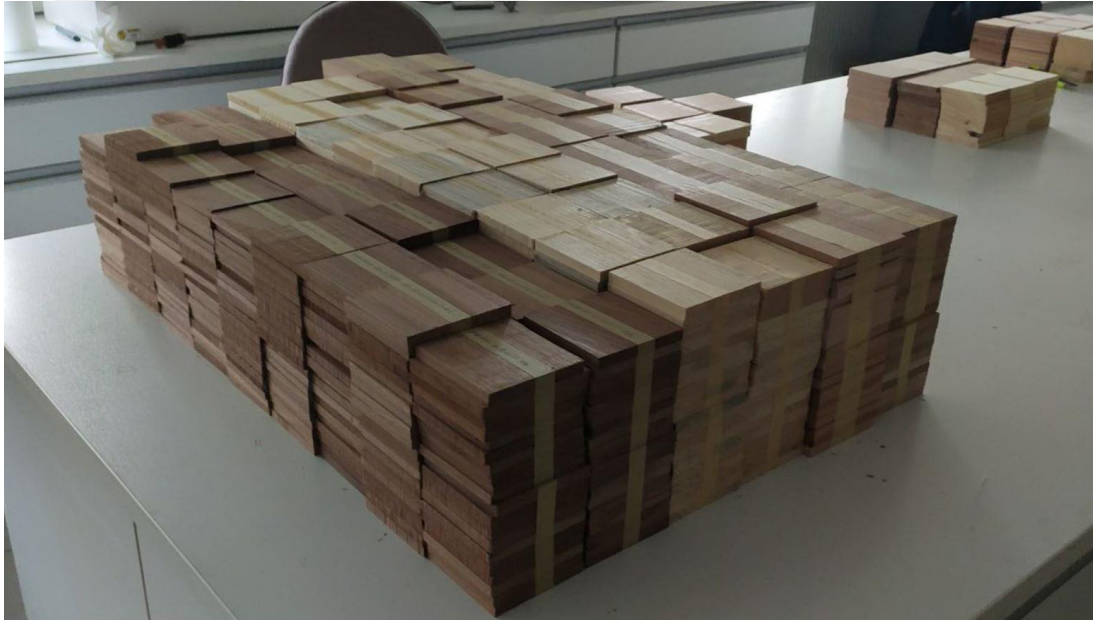
Şekil 5. Maun, sarıçam ve kayın deney örnekleri
