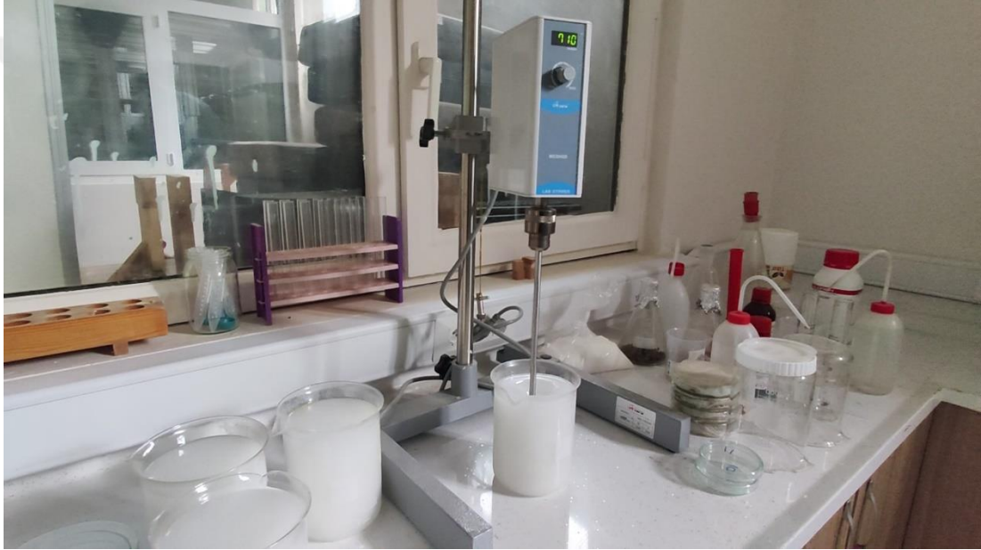
Şekil 7. Homojenizatör ile mekanik karıştırma yöntemi
