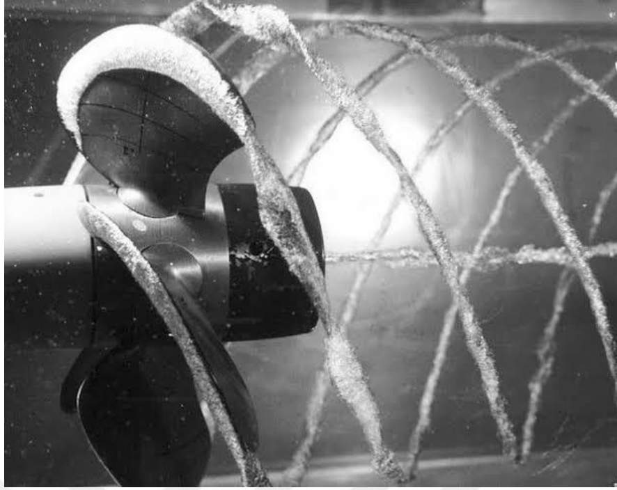
Şekil 1. Pervane kavitasyonu oluşumu
