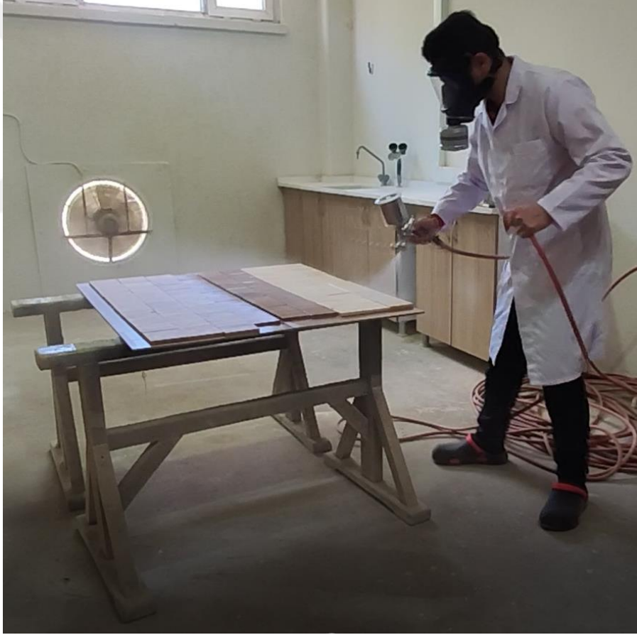
Şekil 9 Vernik sistemlerinin deney örneklerine uygulanması
