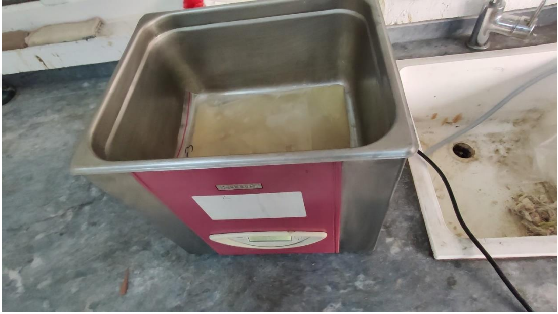
Şekil 8. Ultrason teknesi yardımıyla vernik sistemlerinin karıştırılması
