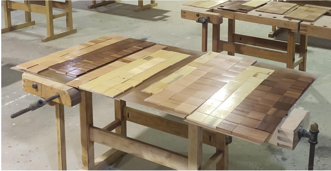
Şekil 10. Vernik sistemleri uygulanmış deney örneklerinin kuruma aşaması
