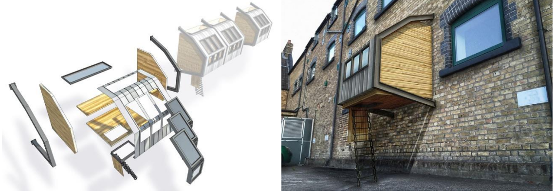
Şekil 2.8. Parazit mimaride montaj kolaylığı; Sleeping Pods (ArchDaily, 2015a)
