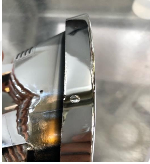
Şekil 3.1. Kaplı parça üzerine soda testinin uygulanması
