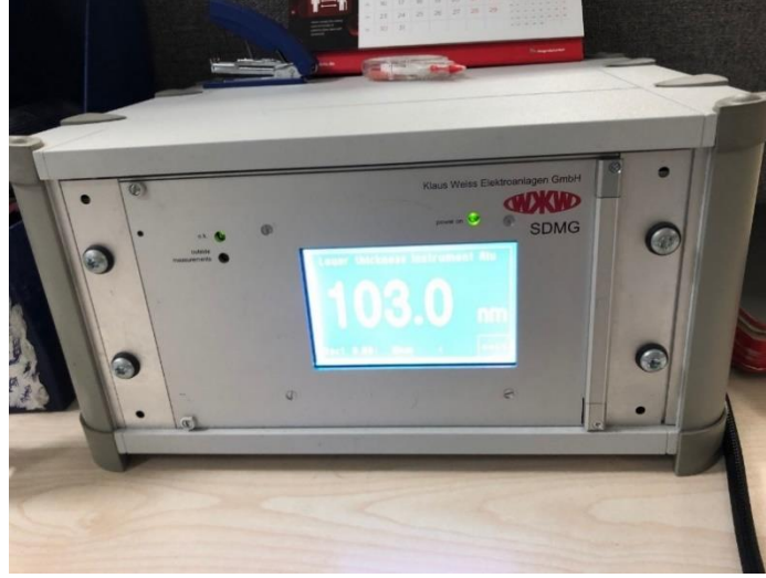
Şekil 3.2. Kaplama kalınlık ölçümlerinin yapıldığı cihaz
