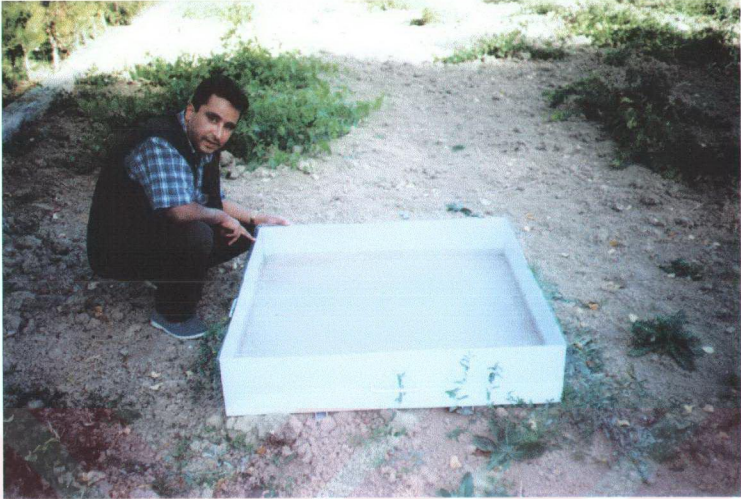
Şekil 3.8. Buharlaşma ve yağış miktarlarının ölçülmesinde kullanılan Class A tipi buharlaşma kabının görünüşü.
