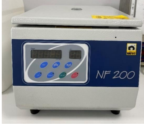
Şekil 3.6: Santrifüj makinesi (Nüve NF200).
