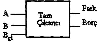
Şekil 8.13: Tam Çıkarıcı Blok Şeması
