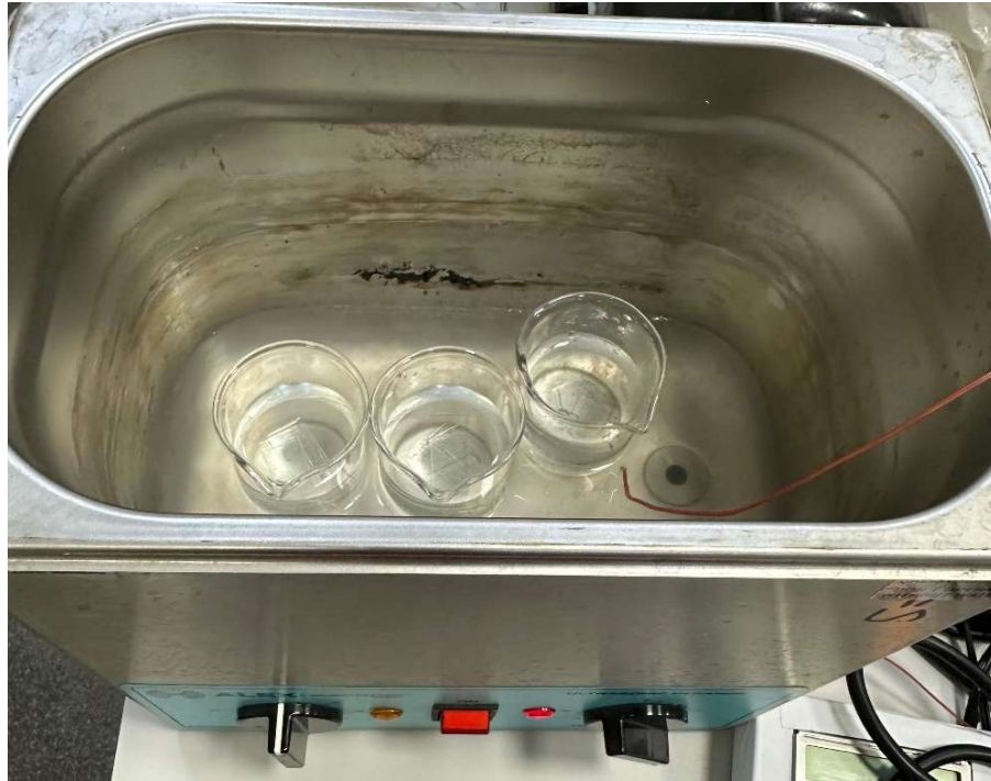
Şekil 3.3. Beherlerin ultrasonik temizleme cihazına yerleştirilmesi.
