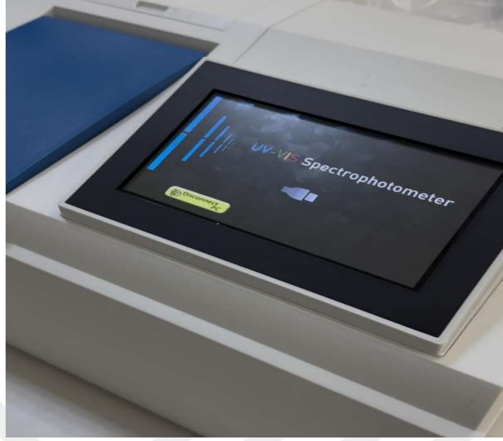
Şekil 3.10. Biyosensör optiksel karakterizasyon testlerinde kullanılan UV-VIS spektrofotometre N4S model ölçüm cihazı.
