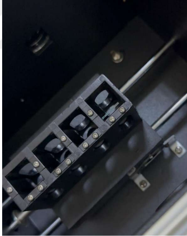
Şekil 3.11. UV-VIS spektrofotometre N4S model ölçüm cihazında ölçümlerin gerçekleştirilmesi için lamaların yerleştirildiği bölüm.
