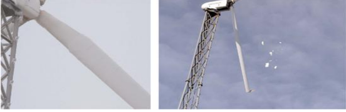
Şekil 2.4.1. Wachusett Rüzgar Enerjisi'ndeki bir rüzgar türbininde buz birikmesi ve düşmesi [9].
