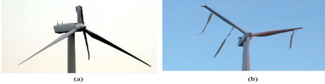
Şekil 2.5.1. (a) 2008'de Kirkheaton'da kırılan 66,5 m'lik bir türbin kanadı; (b) 25 Nisan 2012'de Ohio'da parçalanan ve enkazın etrafa dağıldığı iki kanat [30, 31].
