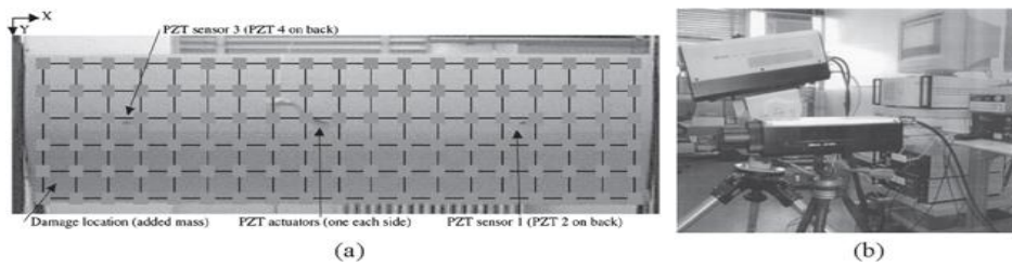
Şekil 3.3.1. (a) Birkaç PZT sensörüyle donatılmış bir rüzgar türbini kanadının üzerine yerleştirilmiş lazer noktaları dizisi; (b) kanadın sapmalarını ölçmek için kullanılan lazer vibrometresi [27].
