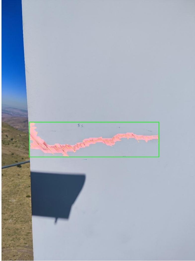
Şekil 6.6.1. Arka kenar çatlağının görüntü işleme yöntemleriyle tespiti
