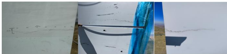
Şekil 4.1.6.1. Arka kenar çatlak hasarı
