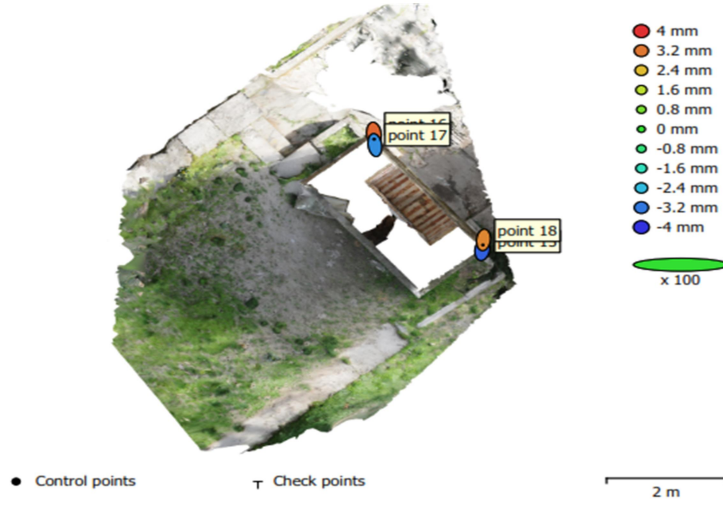
Şekil 5.5. Kontrol noktalarının konumları ve hata elipsleri
