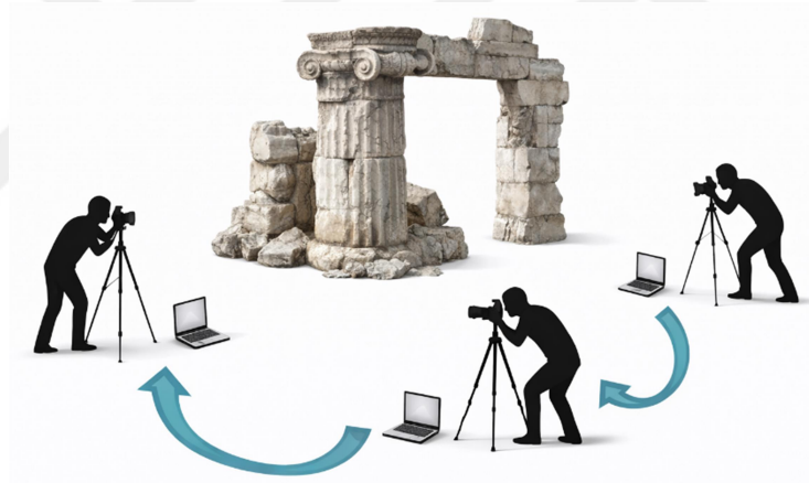
Şekil 2.5. Fotogrametri yaklaşımının şematik gösterimi
