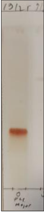
Resim 3.11. ES-O-M alt fraksiyonunun revelatör püskürtüldükten sonra gün ışığındaki görünümü (Revelatör: %1 vanilin sülfürik asit)
