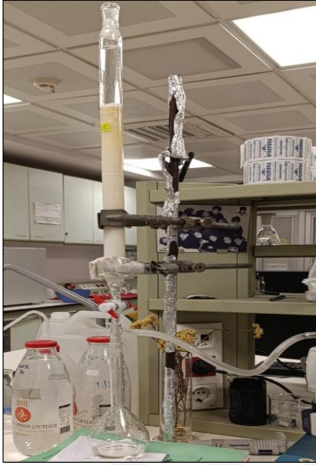
Resim 3.8. Fr H'nın RP-18 kolon kromatografisi ile fraksiyonlanması
