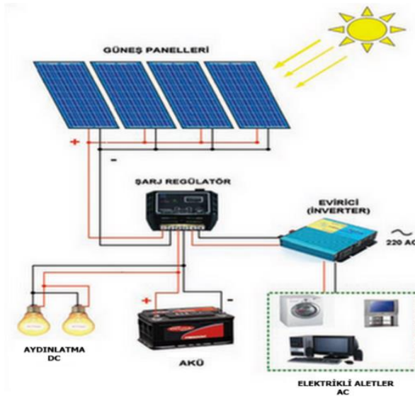
Şekil 1.1 Şebekeden bağımsız güneş enerji sistemi
