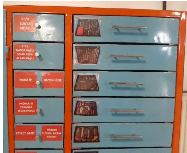
Şekil 4.15: Montaj malzemeleri depolama alanı standartlaştırma 5S uygulama sonrası (Tahta, 2023)
