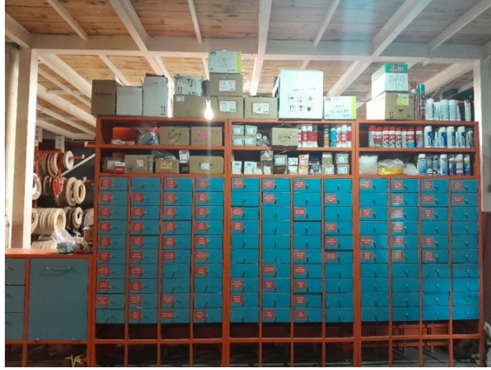
Şekil 4.32: Montaj grubu stok alanı 5S uygulama sonrası (Tahta, 2024)
