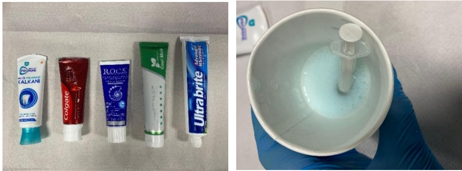
Şekil 23. 1:2 oranında hazırlanmış diş macunu/su karışımı (EN ISO 14569-2007)
