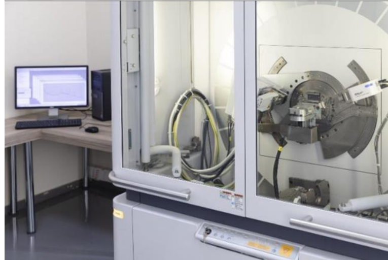
Şekil 23. X ışını kırınım ölçer (Bozkurt,2021)
