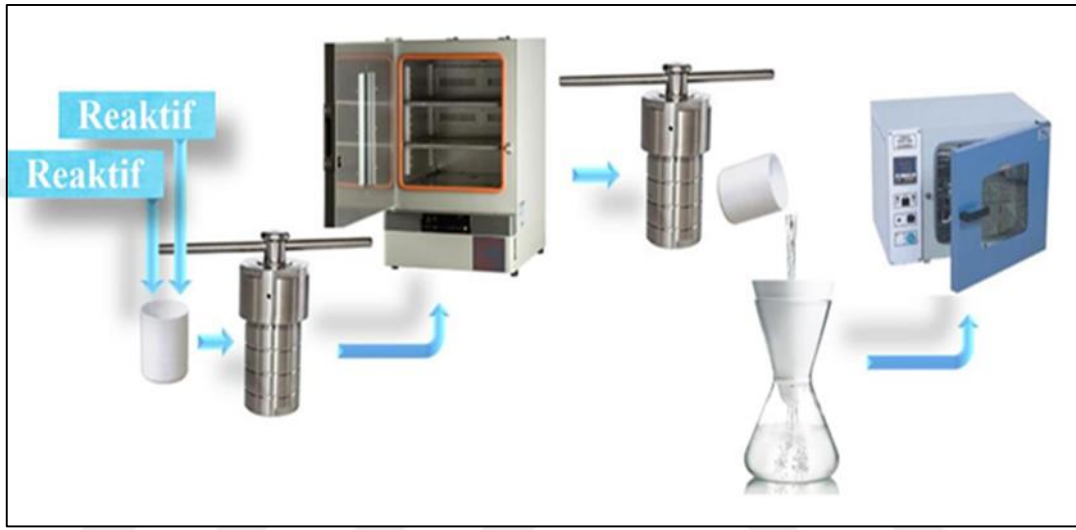
Şekil 10. Solvothermal yönteminin şematik gösterimi (Öztürk 2015)
