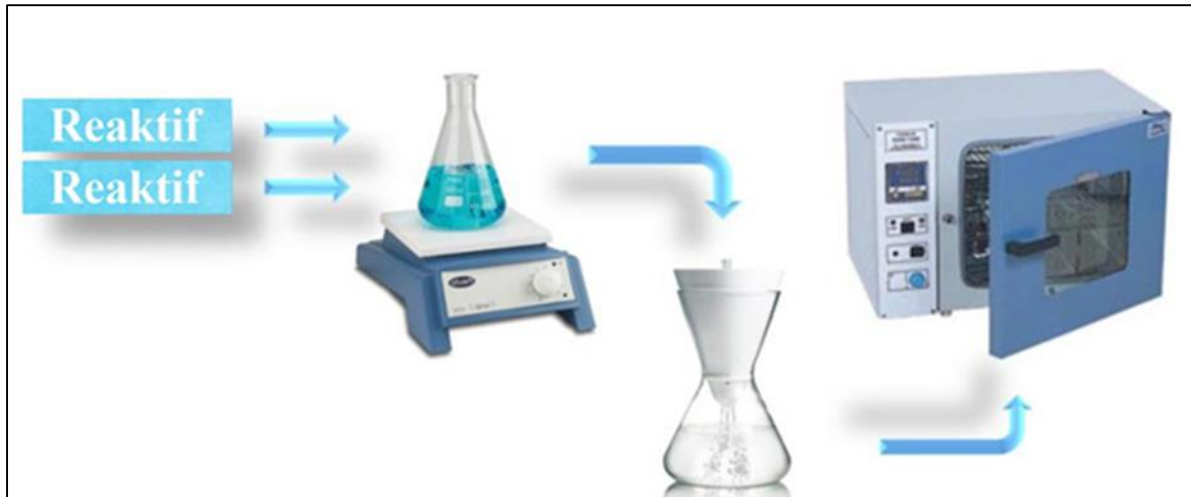
Şekil 9. Oda şartlarında sentez yöntemi (Öztürk 2015)
