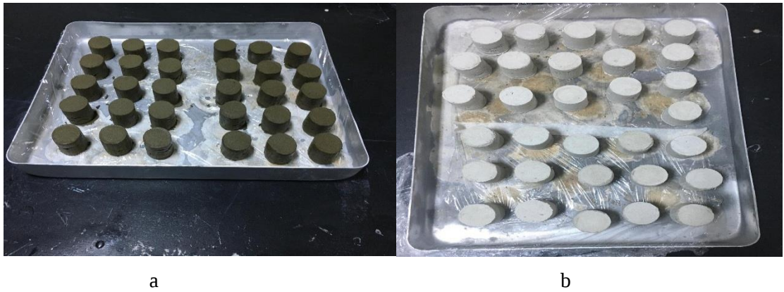
Şekil 3.2. Numunelerin etüvden önce (a), Numunelerin etüvden sonraki görüntüleri (b)
