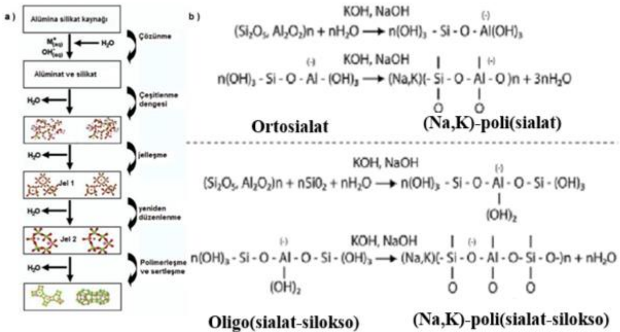
Şekil 2.3. (a) Geopolimerleşmenin kavramsal bir modeli (Duxson et al., 2007),
