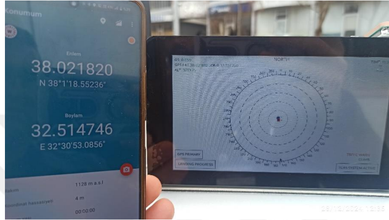
Şekil 22. GPS modülünden alınan konum bilgisinin doğruluğunun test edilmesi
