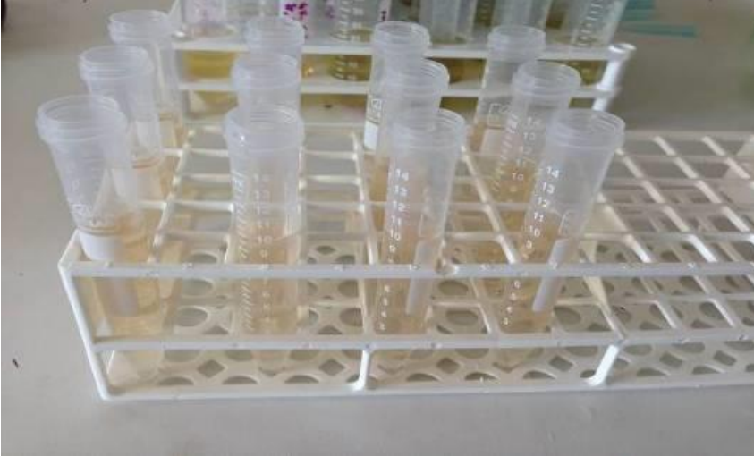
Şekil 3.48. Vortekslenen örneklere %10'luk AlCl_3 ve NaOH ekledikten sonraki renk değişiminden bir görünüm
