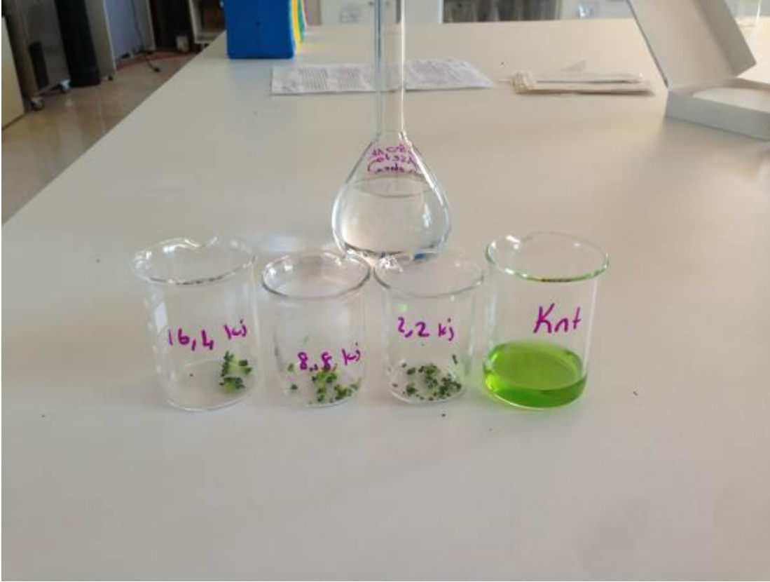
Şekil 3.51. 0.25 g taze örneğin %80'lik 10 ml aseton ile homojenizatörde parçalandıktan sonraki görünümü
