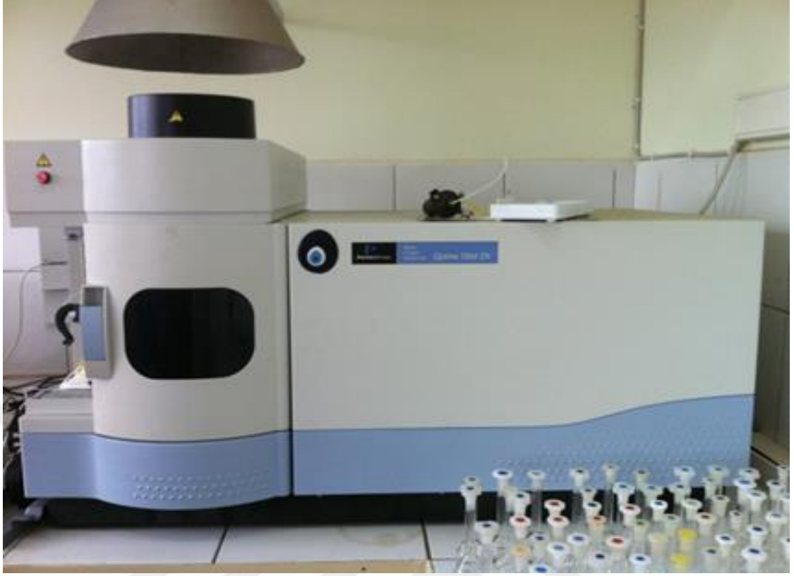
Şekil 3.29. Mikro ve makro element analizi için örneklerin okutulduğu ICP cihazından bir görünüm
