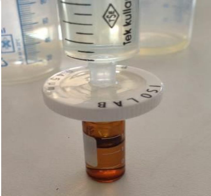
Şekil 3.53. 0.45 µm membran filtreden geçen örneklerin HPLC için viallere alınması
