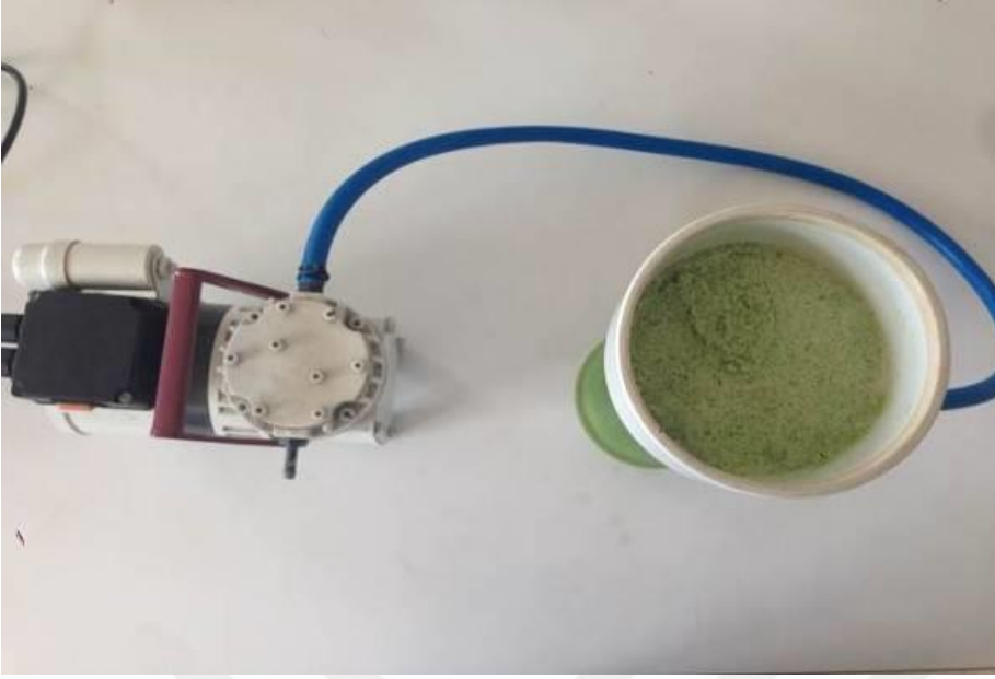
Şekil 3.44. Vakum yardımıyla Buchner hunisine yerleştirilmiş Whatman No.2 kağıdından örneğin süzdürülmesi işleminden bir görünüm
