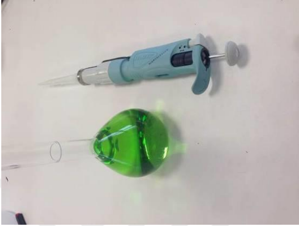
Şekil 3.46. Epifazik katmanın filtre kâğıdı yardımıyla fitre edildikten sonraki berrak ekstrakt
