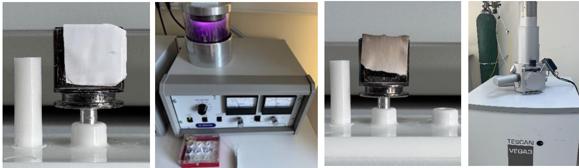
Şekil 20 Membran örneğinin Au/Pd kaplamasının yapılması
