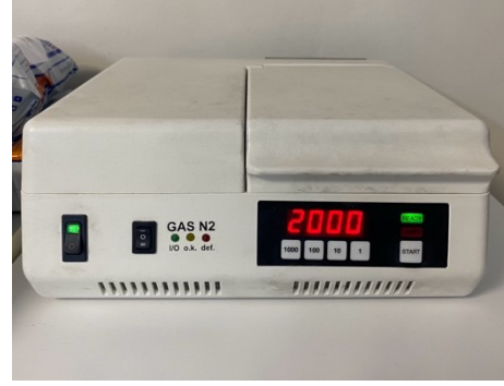
Şekil 17. DLP teknolojisini kullanan üç boyutlu yazıcı ve post-kür amacıyla kullanılan polimerizasyon cihazı
