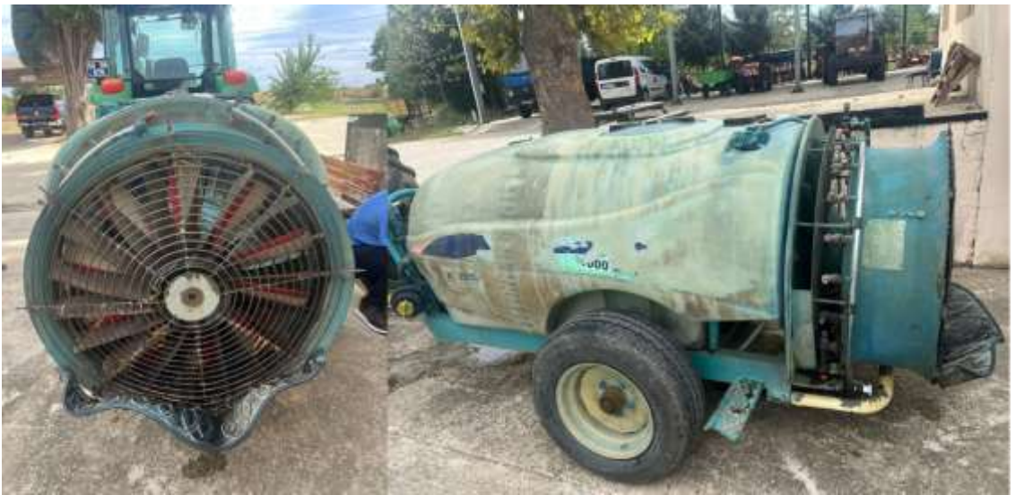
Şekil 2.1. Denemeler sırasında kullanılan yardımcı hava akımlı pülverizatör.
