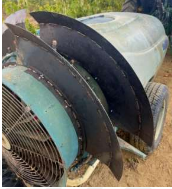
Şekil 2.13. Parçanın arkaya doğru montajlanan durumu
