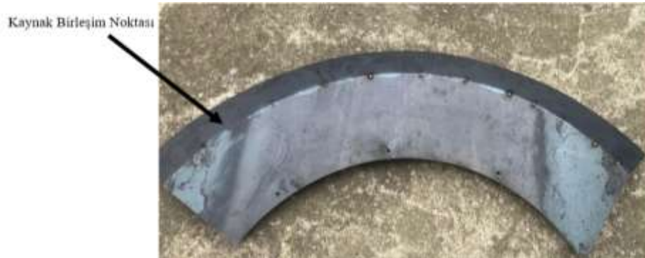
Şekil 2.10. Parçanın kaynaklanmış hali
