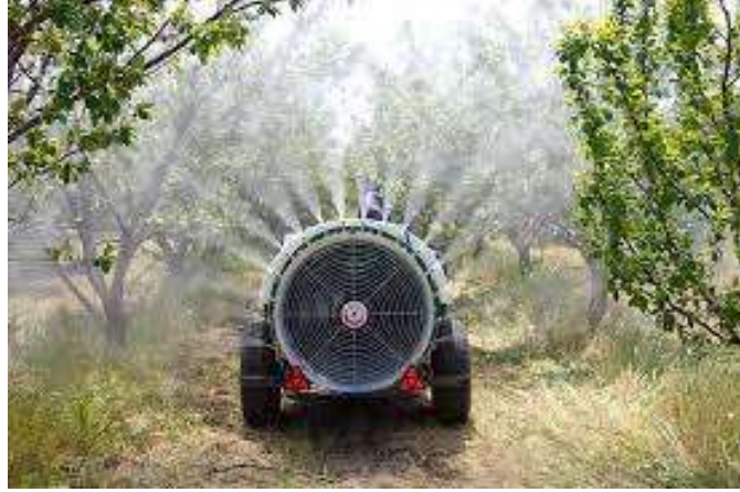
Şekil 1.5. Eksenel fanlı yardımcı hava akımlı bahçe pülverizatörünün görüntüsü (Anonim, 2025d)
