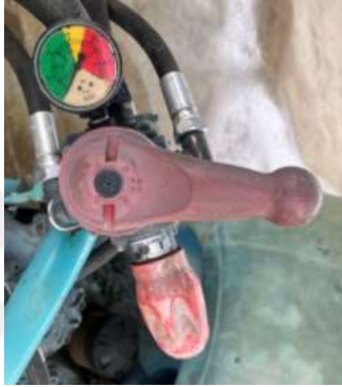
Şekil 2. 2 Makinenin üzerinde takılı olan manometre ve regülatör
