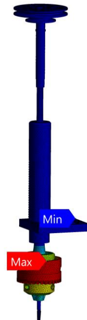
Şekil 24. 4340 ve 100 mm, şaft açıklığına sahip Modal Analiz sonuçları
