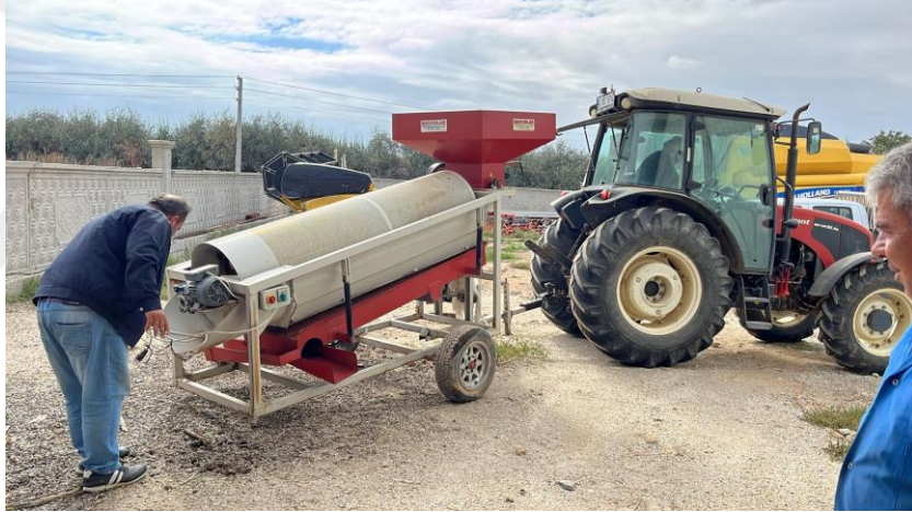
Şekil 3.27 Harman İçin Haşhaş Kırma Makinası Kullanılmıştır
