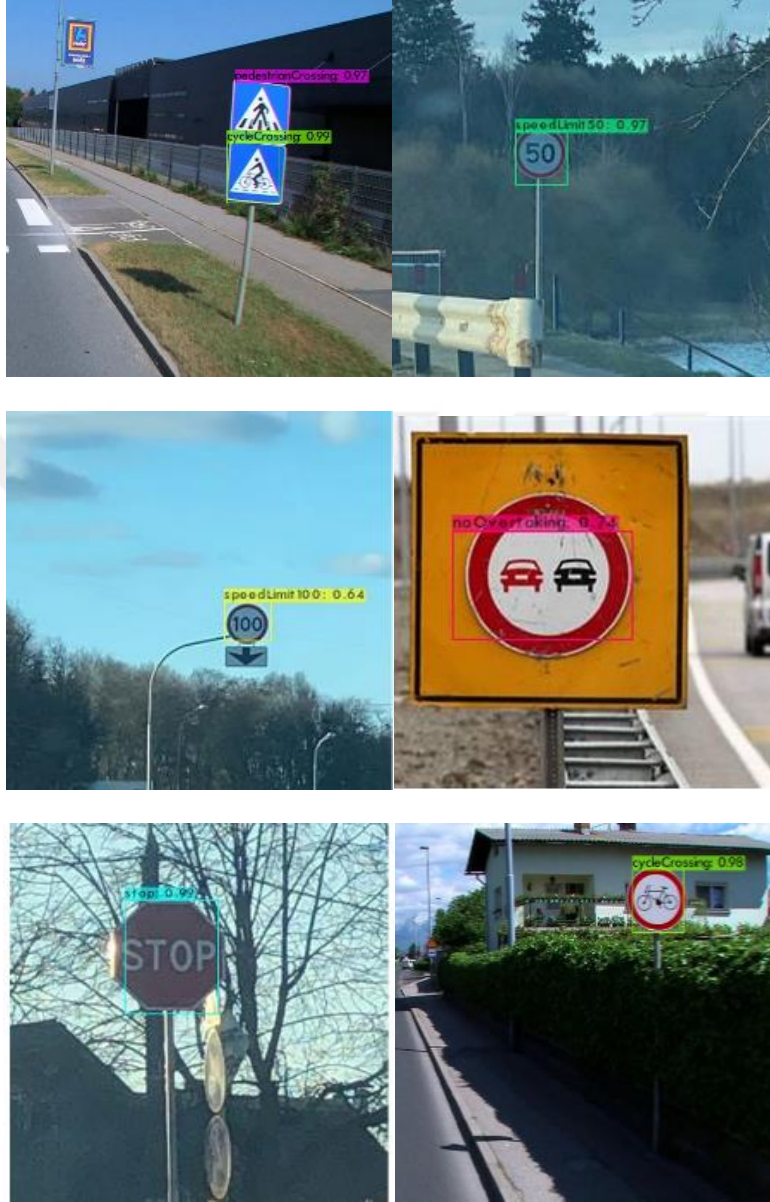
Şekil 3.8 : Trafik işareti algılama sonucu örneği.
