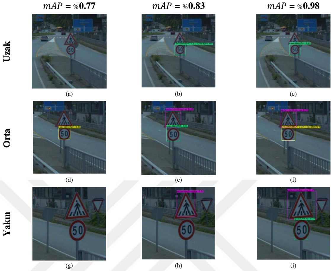
Şekil 4.4 : Farklı açı ve mesafelerde artan mAP değeri ile elde edilen test sonuçları.
