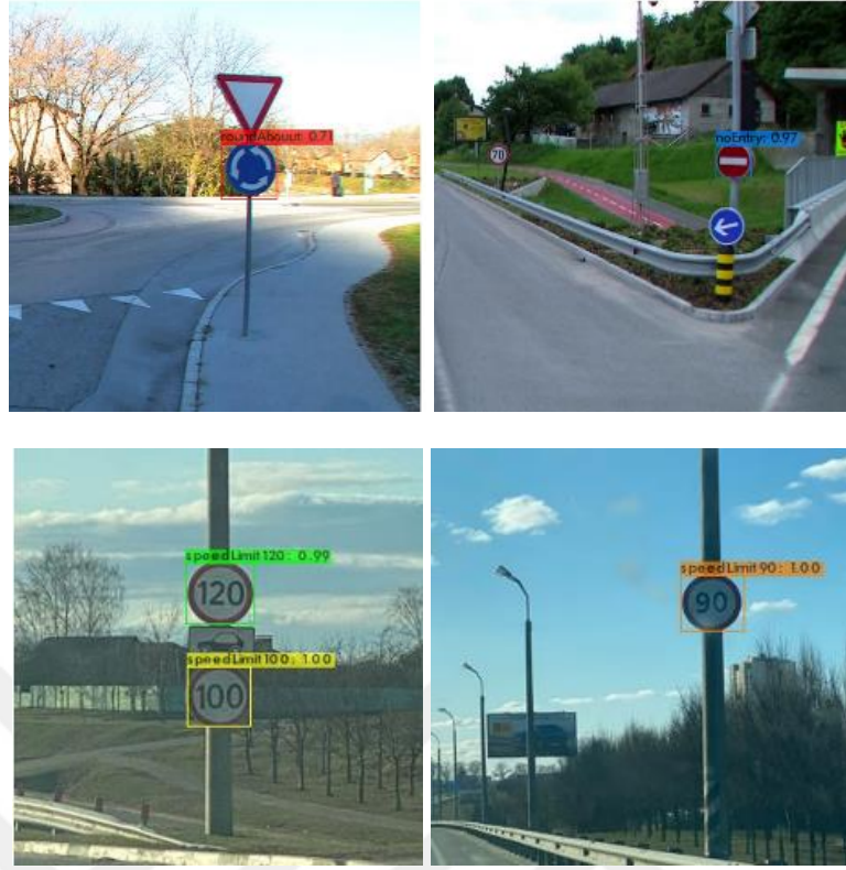
Şekil 3.9 : Trafik işareti algılama sonucu örneği.
