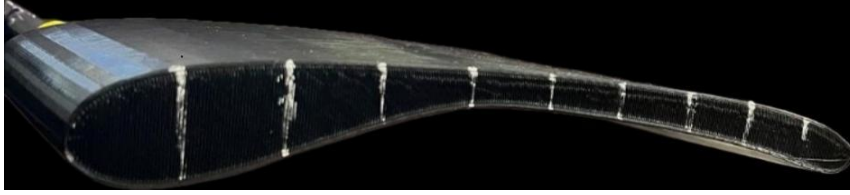
Şekil 4.4: Kanat Profili Yüzey Prob Kullanım Noktaları (x/c)
