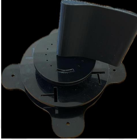
Şekil 3.9: Kuvvet Sistemine Kanat Modelinin Montajı
