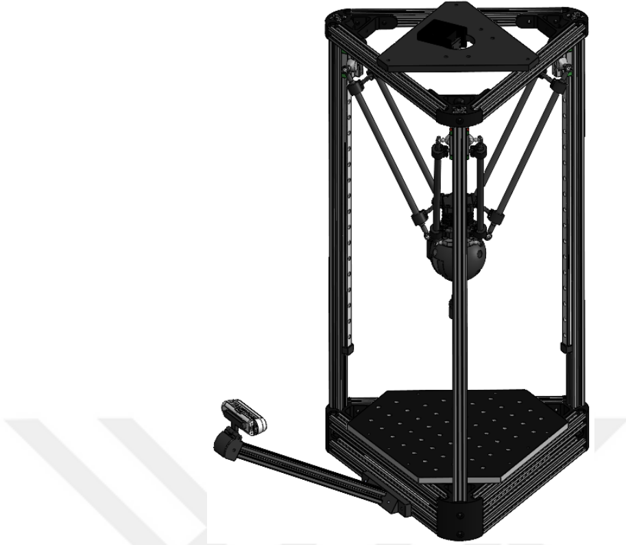
Şekil 4.12 : Intel derinlik kamerasının delta robota montajının genel görünümü [42].
