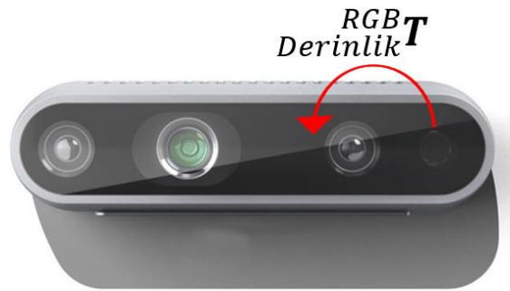
Şekil 4.6 : Derinlik kamera ekseninin RGB eksenine göre dönüşüm matrisi [41].
