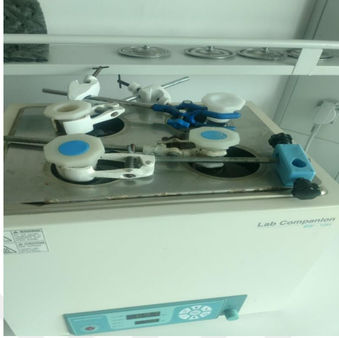
Resim 2.4. Dietilaminoetilmetakrilat-Etilmetakrilat 'ın su banyosunda kopolimerizasyonu
