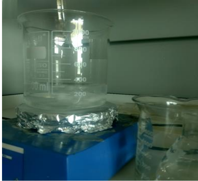
Resim 2.5. Poli(DEAEMA-ko-EMA)'nın çöktürme işlemi
