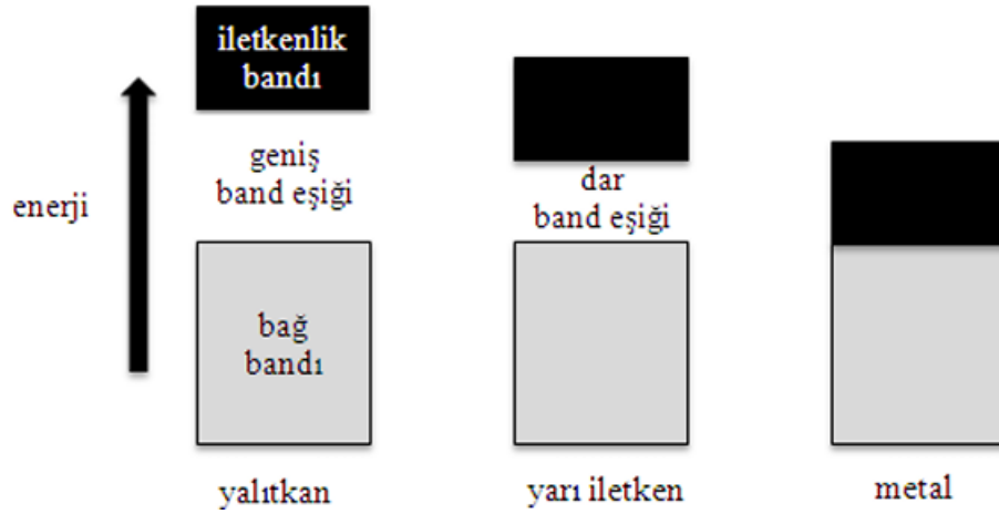
Şekil 1.5. Yalıtkan, yarı iletken ve iletken maddelerde bant aralığı (Saçak, 2008)
