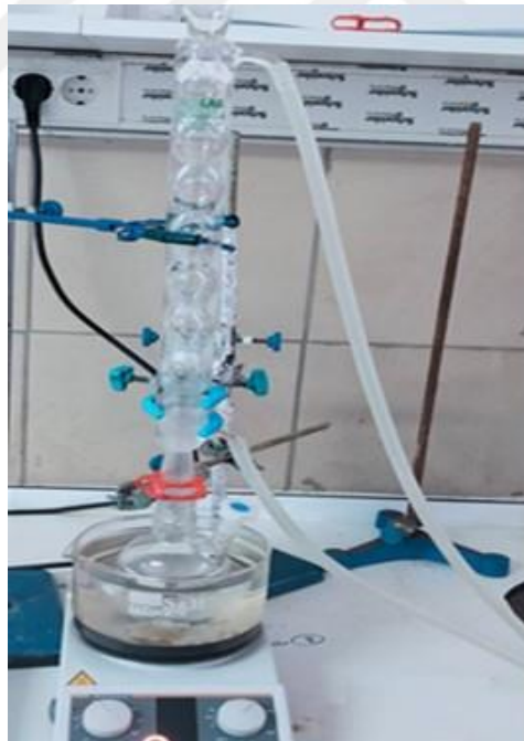
Şekil 3.2: Fonksiyonelleştirme İşleminde Kullanılan Reflux Düzeneği
