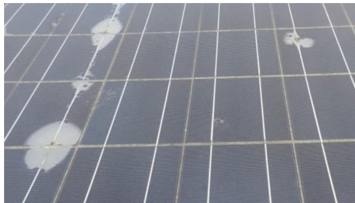
Şekil 44. Kabarcıklanma noktaları bulunan panel (Maysun Solar, 2022)
