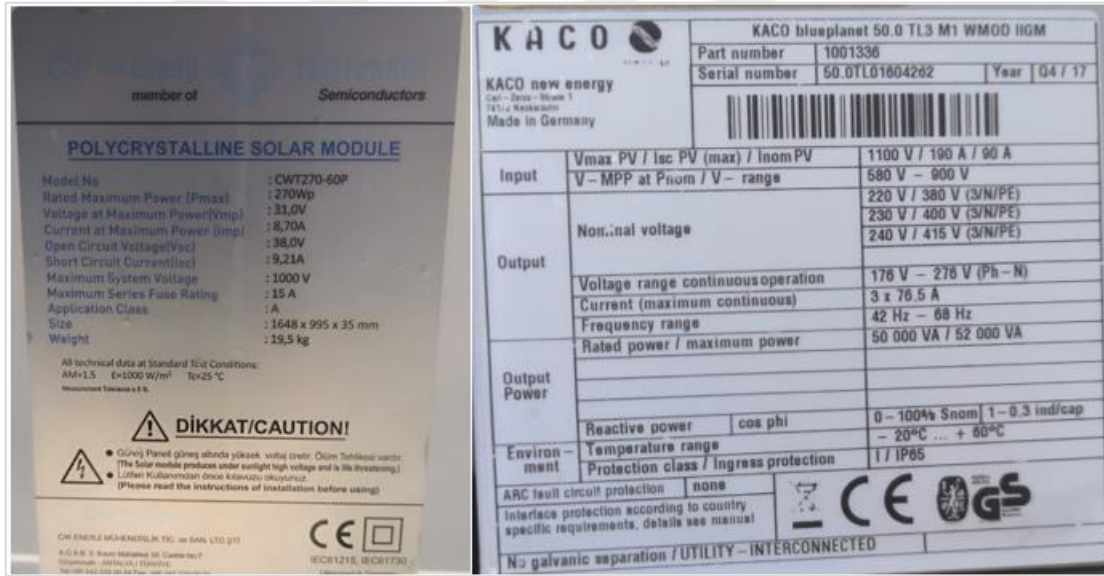
Şekil 68. PV panel (solda) ve invertöre (sağda) ait teknik özellik etiketleri
