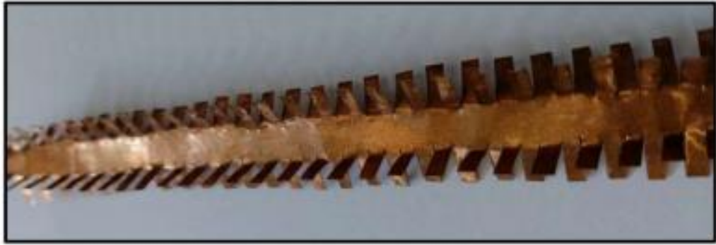
Şekil 2.22 Kanatçık olarak kullanılan bakır levha (Hassan et al. 2022)
