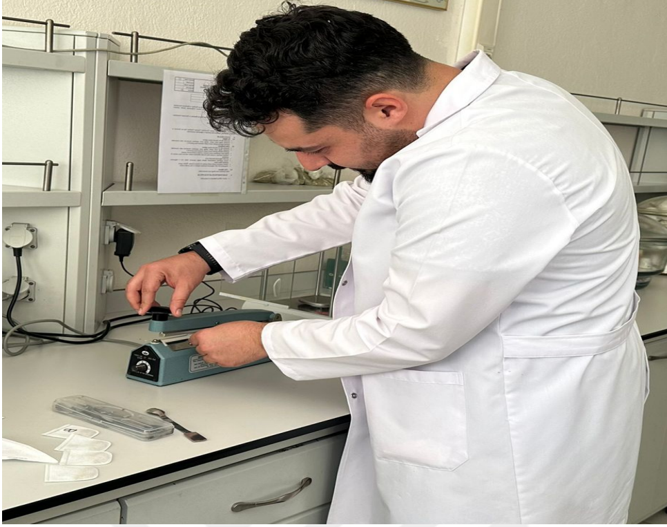
Şekil 4. In vitro sindirim değerlendirmesi için filtre kese ve numunelerin hazırlanması.
