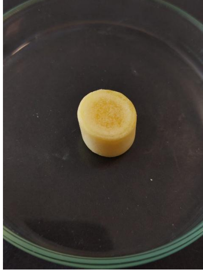
Şekil 4.34: Benzin absorpsiyonu sonrası monolit M 5 .
