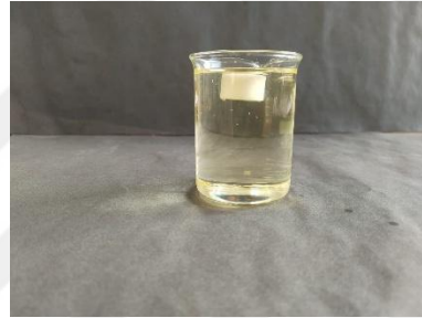
Şekil 4.38: Hafif PEG monoliti ( M_5 ) yoğunluğu düşük benzin sıvısında askıda dururken.
