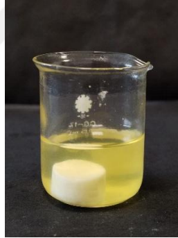
Şekil 4.35: Monolit benzinde absorpsiyon (M 5 ).
