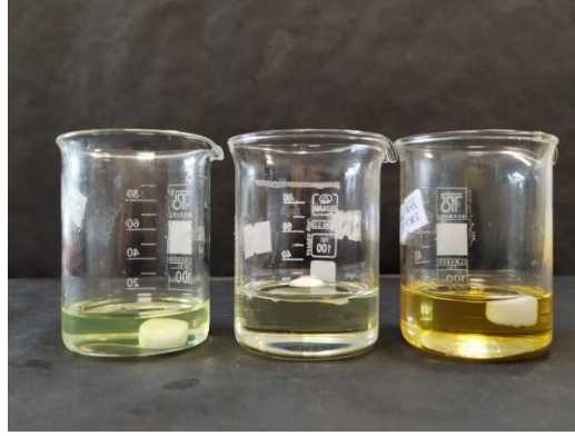
Şekil 4.37: Monolitin ( M_8 ) benzin; ayçiçek yağı ve oleik asitte absorpsiyonu.
