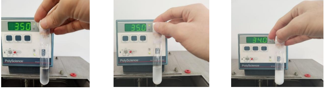
Şekil 4.30: M 7 monoliti bulutlanma noktası ve monolit oluşumu.
