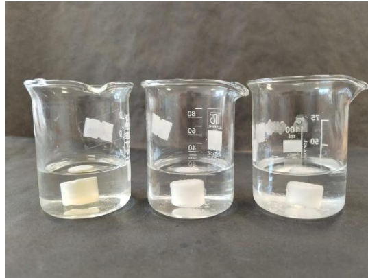
Şekil 4.39: Monolitlerin absorpsiyon sonrasında hekszanda desorpsiyon işlemi (soldan sağa; benzin, ayçiçek yağı ve oleik asit absorblamış monolitler).
