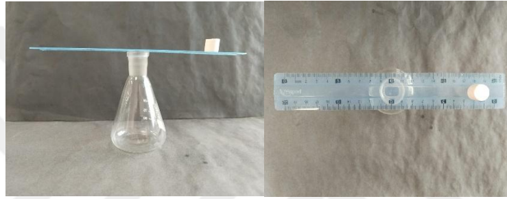
Şekil 4.7: Dengede duran hafif PEG monoliti ( M_5 ).
