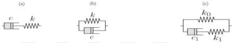
Şekil 3.5. Geleneksel viskoelastik modeller: (a) Maxwell modeli (Denklem (3.3, 3.6 ve 3.9), (b) Kelvin-Voigt modeli (Denklem 3.4, 3.7 ve 3.10) ve (c) Zener modeli (Denklem 3.5, 3.8 ve 3.11).
