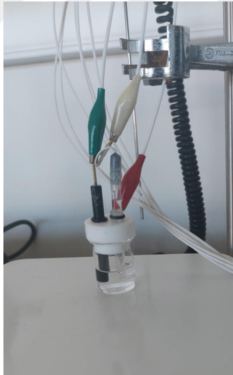
Şekil 3.9 Tez çalışmasında kullanılan üçlü elektrot sistemi.
