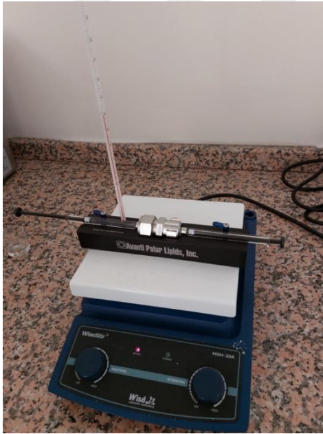
Şekil 3.4 Ekstrüzyon işleminde kullanılan ekstruder cihazının görünümü.
