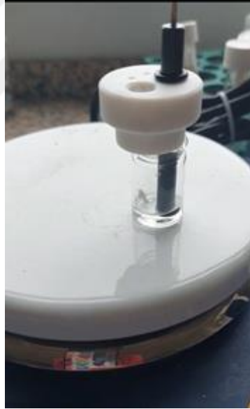
Şekil 3.10 Film kaplı elektrodun inkübe edilme aşaması.
