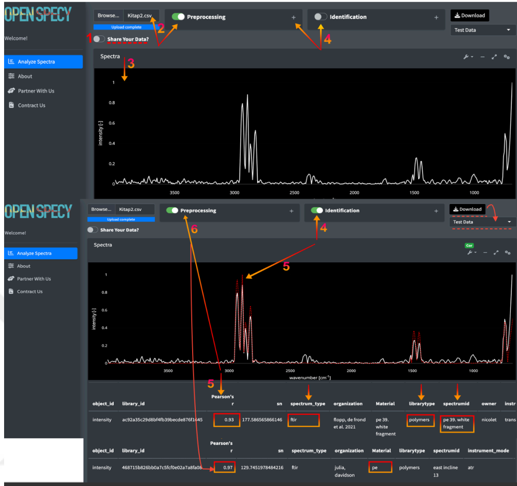
Şekil 8. OpenSpecy spektrum karşılaştırılması: Beyaz spektrum: Bu çalışmada analiz edilen MP spektrumu, Kırmızı spektrum: OpenSpecy kütüphanedeki eşleşen spektrum
