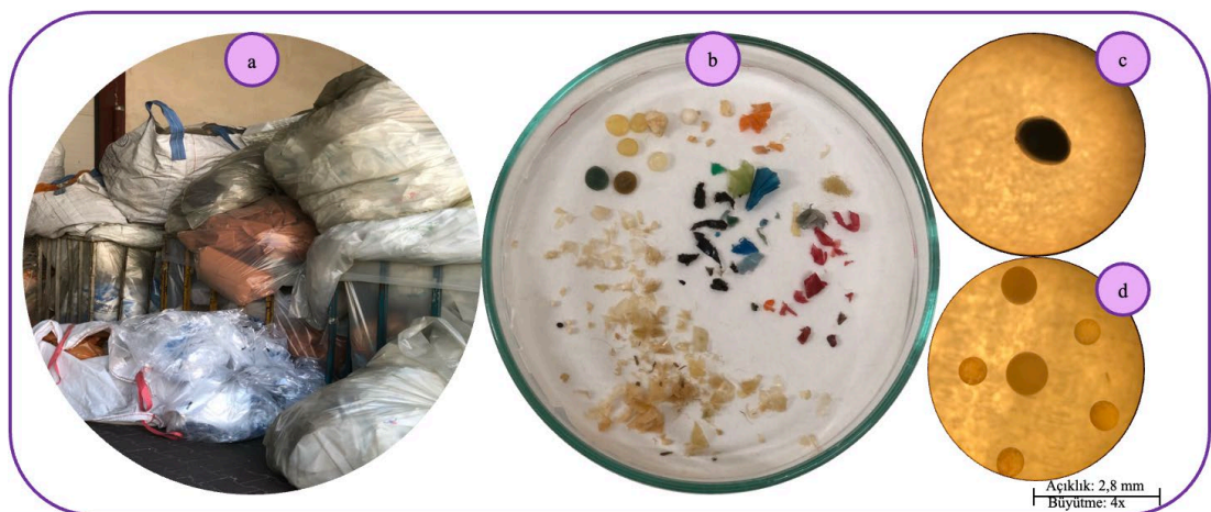
Şekil 60. PGDT3: a) Toplanan poşetler ve torbalar, b) Renklerine göre ayrılan MP şekilleri: parçacık, film, pelet (granül), köpük, Mikroskop görüntüleri: c) Siyah boncuk (5000-1000 µm), d) şeffaf ve beyaz boncuklar (1000-600 µm)
