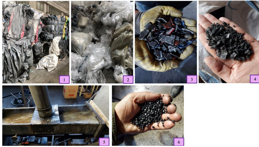
Şekil 61. PGDT4: 1-2-3-4) Eritilecek poşetler ve kırılmış sert plastikler, 5) MP granüllerinin soğutulması, 6) Üretilen granüller
