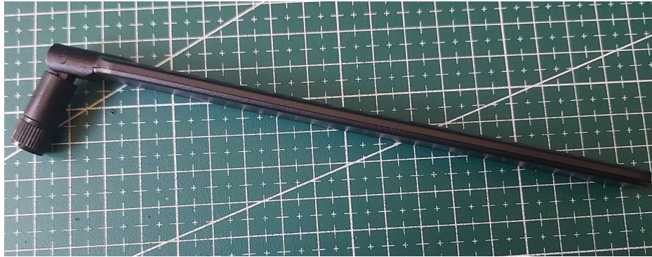
Şekil 3.7: 5.0dB 900 MHz anten.
