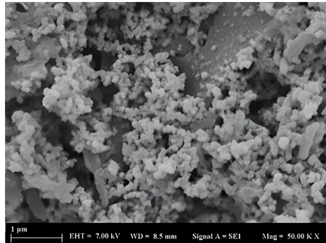
Şekil 4.18 Süper kritik CO 2 ekstraktı yüklü nanopartiküllere ait 50.000X büyütme oranı ile çekilmiş SEM görüntüsü
