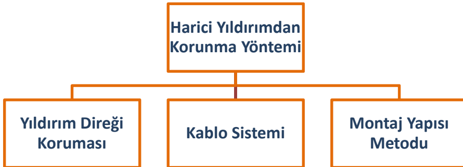
Şekil 2.5. PV sistemlerinde ‘harici yıldırımdan korunma’ çözümü ve bileşenleri. [29]
