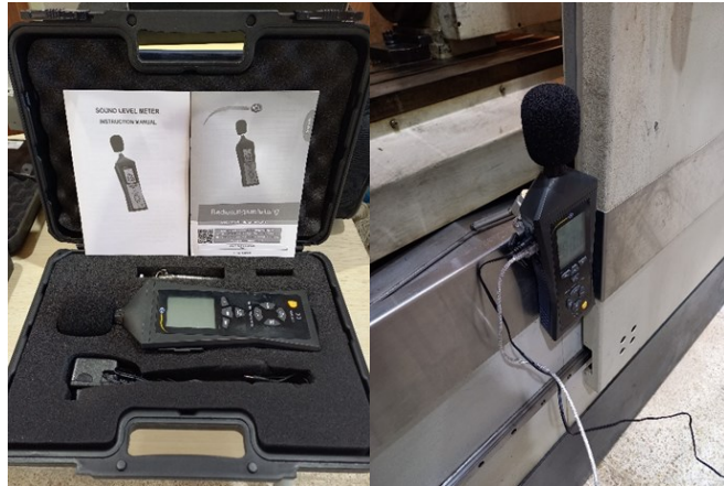
Şekil 4.10. PCE marka 322A ses seviye ölçme cihazı ve ölçümü
