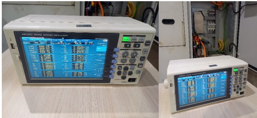
Şekil 4.12. HIOKI marka 3390 model güç analiz cihazı ve ölçümü
