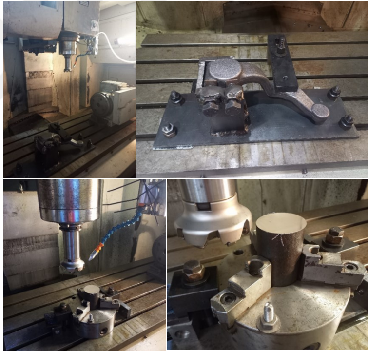
Şekil 4.1. Traktör direksiyon kolu ve Ø60mm AISI 1040 imalat çeliği
