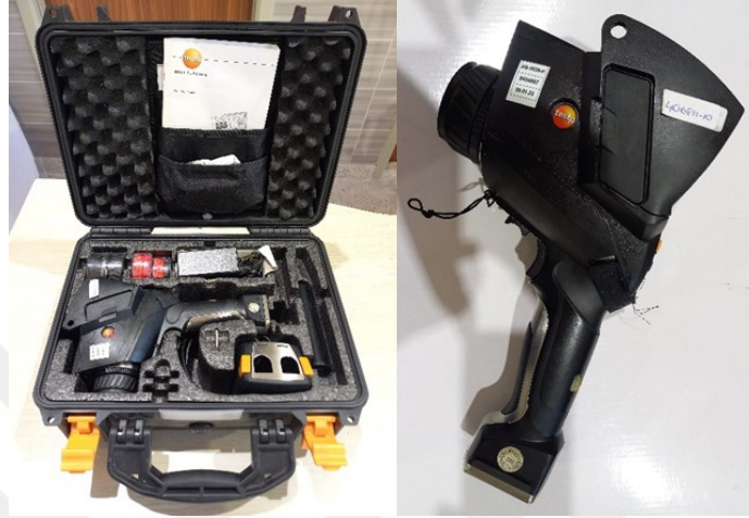
Şekil 4.11. Testo marka 881 model termal kamera cihazı
