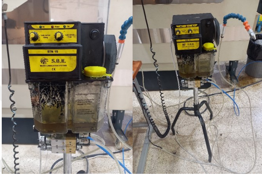
Şekil 4.5. Werte marka mikro stn 15 model minimum miktar yağlama cihazı
