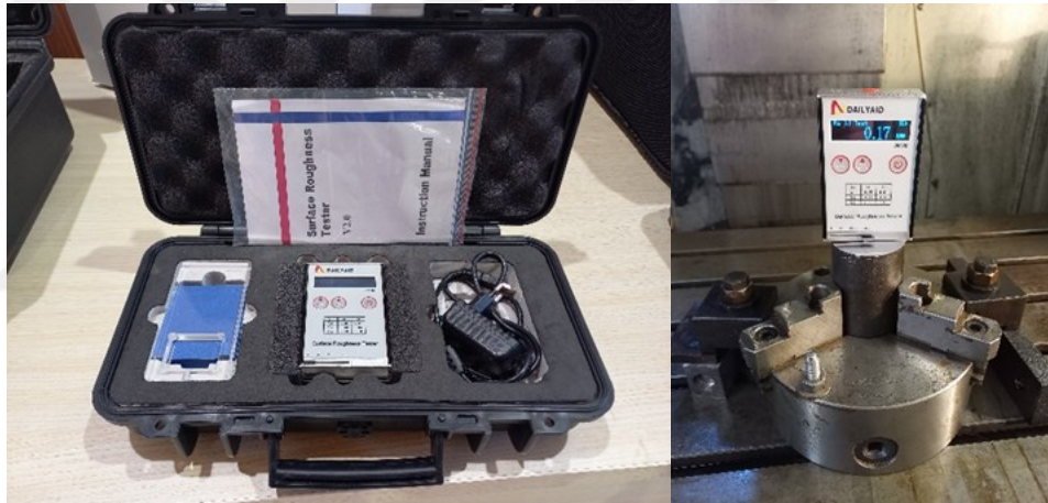
Şekil 4.8. Dailyaid marka DR100 model yüzey pürüzlülük cihazı ve AISI 1040 imalat malzemesi ölçümü
