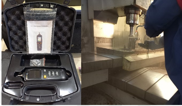
Şekil 4.9. PCE marka VT 1300 model titreşim ölçme cihazı ve ölçümü
