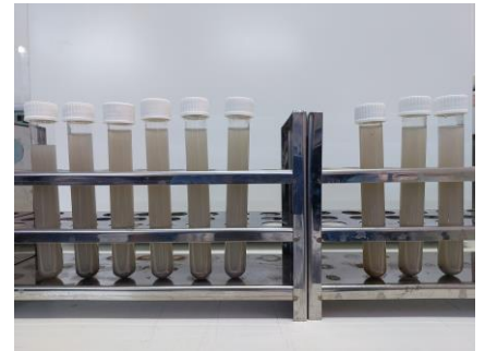
Şekil 4.2. Kağıt geri dönüşüm atıksuyunun grafit elektrotlar kullanılarak EO prosesiyle KOİ ve renk gideriminin reaksiyon süresiyle değişimi
