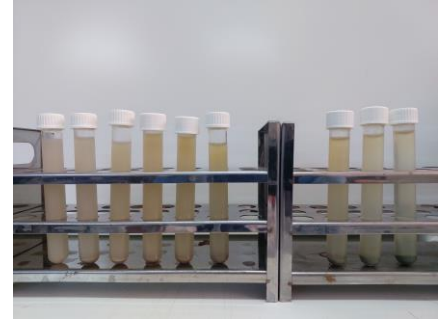
Şekil 4.3. Kağıt geri dönüşüm atıksularının çelik elektrotlarla elektrokimyasal oksidasyon prosesiyle arıtımında, 2.5 cm elektrotlar arası mesafe için, KOİ ve renk gideriminin zamanla değişimi (Elektrotlara uygulanan potansiyel: 10 V)
