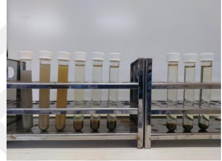
Şekil 4.14. Kağıt geri dönüşüm atıksularının çelik elektrotlarla elektrokimyasal oksidasyon prosesiyle arıtımında, 0.01 M \text{Na}_2\text{SO}_4 elektrolit ilavesiyle, KOİ ve renk gideriminin zamana bağlı değişimi (Elektrotlar arası mesafe: 2.5 cm, Uygulanan potansiyel: 10 V)
