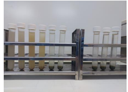
Şekil 4.6. Kağıt geri dönüşüm atıksularının çelik elektrotlarla elektrokimyasal oksidasyon prosesiyle arıtımında, elektrotlara uygulanan potansiyelin 5 V olması halinde, KOİ ve renk gideriminin 30 dakikalık zaman periyotlarında değişimi (Elektrotlar arası mesafe: 2.5 cm)
