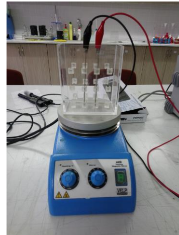
Şekil 3.2. Elektrokimyasal oksidasyon deneylerinde kullanılan güç kaynağı ve reaktör
