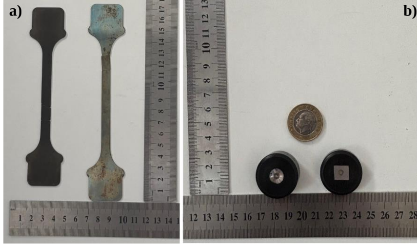
Şekil 3.5. a) Çekme ve b) aşınma testleri sonrası hadde ve SLM numuneler.
