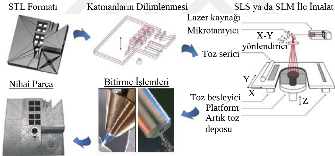
Şekil 2.13. SLS ve SLM imalat şeması [73].
