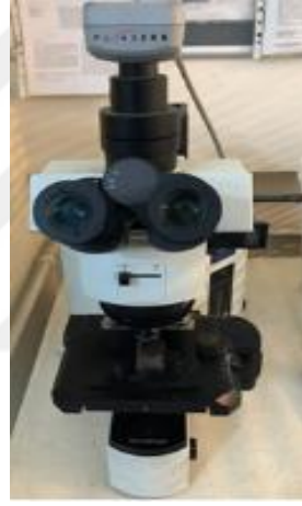
Şekil 3.8. OLYMPUS, BX51M optik mikroskop.
