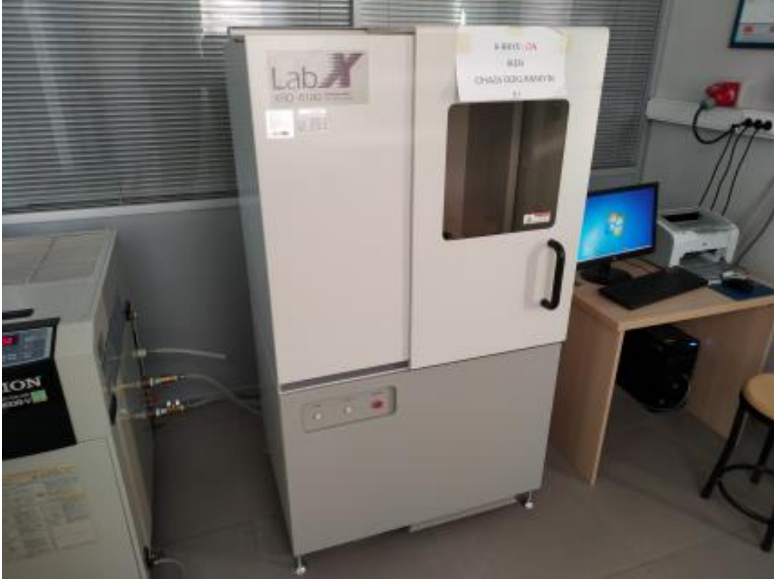
Şekil 3.13. Shimadzu marka LabX XRD-6100 model XRD cihazı.
