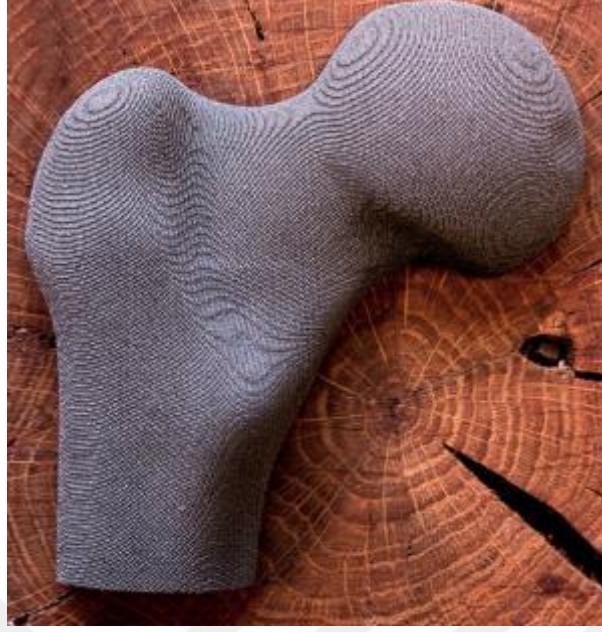
Şekil 1.19. Ti-6Al-4V alaşımından SLM ile üretilmiş gözenekli uyluk kemiği [39].
