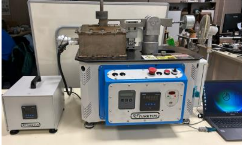
Şekil 3.11. Turkeyus marka POD/HT/WT model aşınma cihazı.
