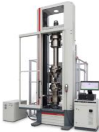
Şekil 3.10. Zwick marka Z600 model çekme testi cihazı.
