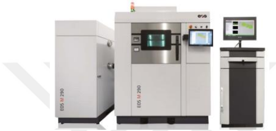
Şekil 3.2. EOS M290 SLM cihazı.
