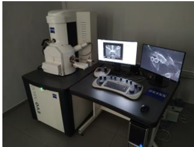
Şekil 3.12. Zeiss marka, Evo-MA10 model SEM.
